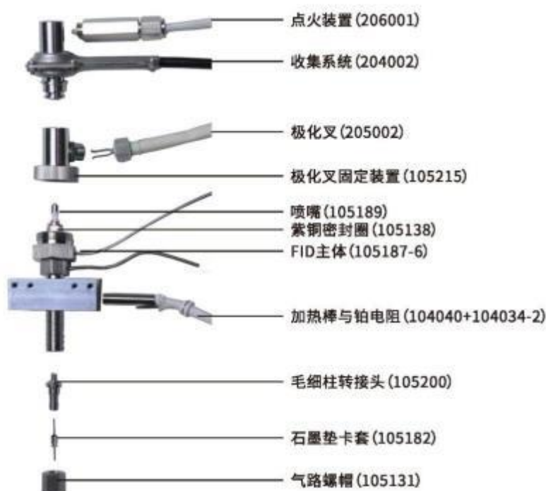
图 1.8 氢火焰离子化检测器（FID）结构图
